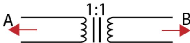
Figure 13 : Un transformateur d'isolement reliant deux circuits, A et B
